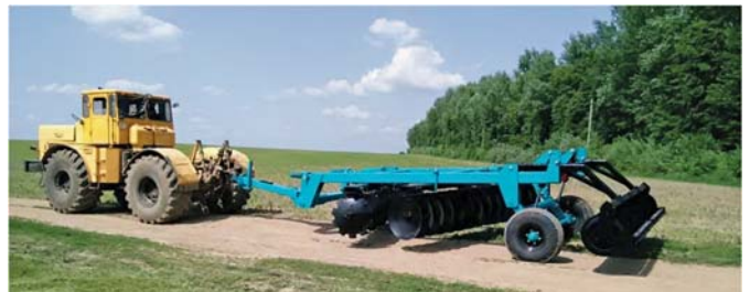
Рис. 4 – Загальний вигляд диско-чизельного агрегата БДВП 4,2-01 з одночасним внесенням рідких добрив
