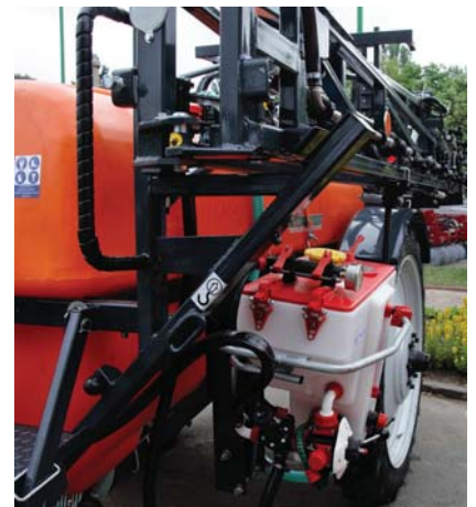
Рис. 8 – Міксер-змішувач фірми «Polmac» (Італія)
