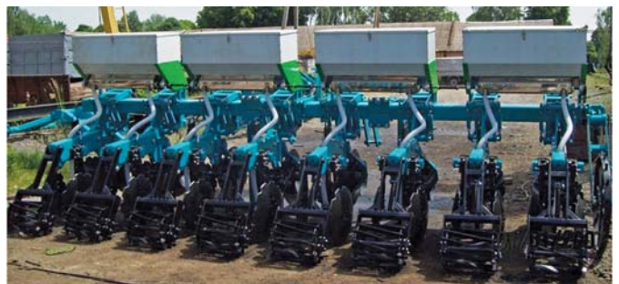
Рис. 5 – Робочі органи до агрегата АСОГ для смугового обробітку ґрунту
