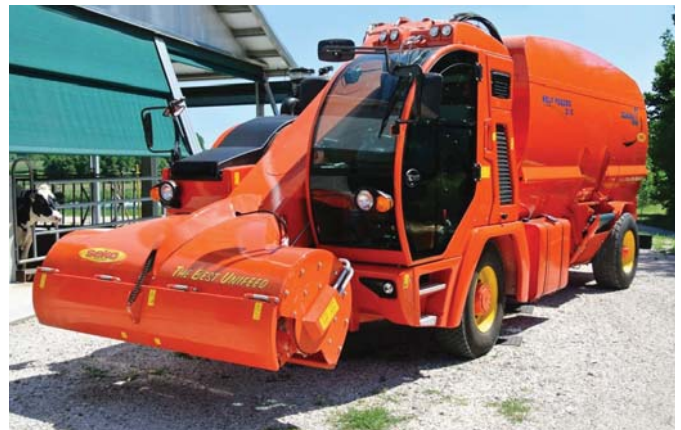
Рис. 22 – Фермський комбайн з горизонтальними робочими органами Samurai 7
