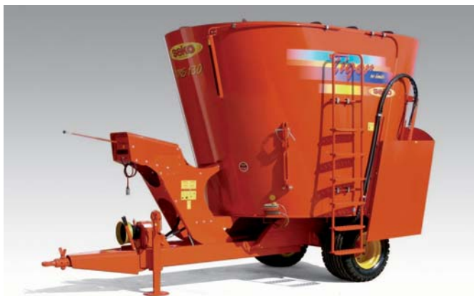
Рис. 13 – Причіпний фермський комбайн Tiger VMS з одним конічним шнеком
