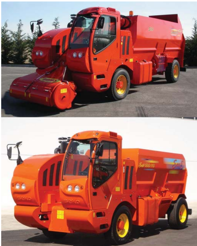
Рис. 20 – Фермський комбайн Samurai 5, обладнаний двома горизонтальними шнеками з фрезою і без фрези
