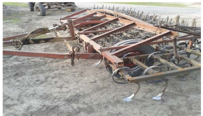
Рис. 3 – Секція культиватора, обладнана дослідними зразками лап
