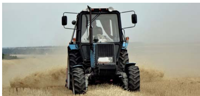
Рис. 8 – Мульчувач УМС-170 забезпечує подрібнення та розсіювання соломи пшениці фактично по всій ширині захвату жатки комбайна, з якої сформовано валок
