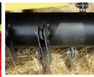
Рис. 5 – Ротор з робочими органами: центральна труба та двобічні ножі
