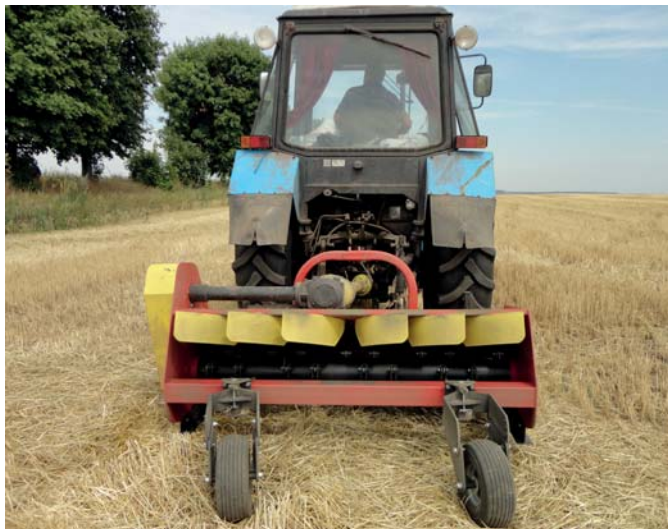
Рис. 1 – Мульчувач соломи УМС-170 в агрегаті з трактором МТЗ-892
