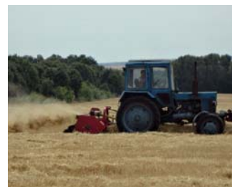
Рис. 7 – Мульчувач УМС-170 в агрегаті з трактором МТЗ-892 під час подрібнення та розсіювання соломи озимої пшениці з валка
