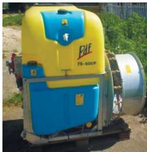
Рис. 6 – Обприскувач навісний вентиляторний NOBILI PDF виробництва «Nobili S.p.A» (Італія)
