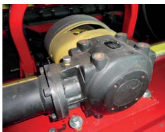
Рис. 4 – Редуктор механічного приводу мульчувача УМС-170
