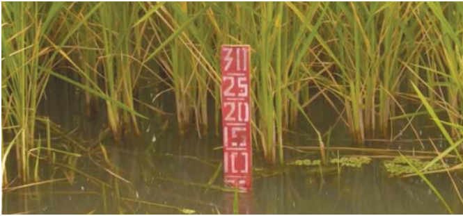
Рис. 3 – Водомірний пристрій визначення шару води у рисовому чеку
